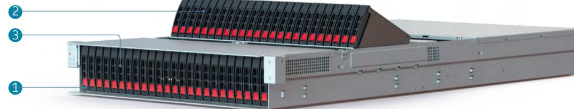
Установленные 48x2'5 диска в дисковую корзину
